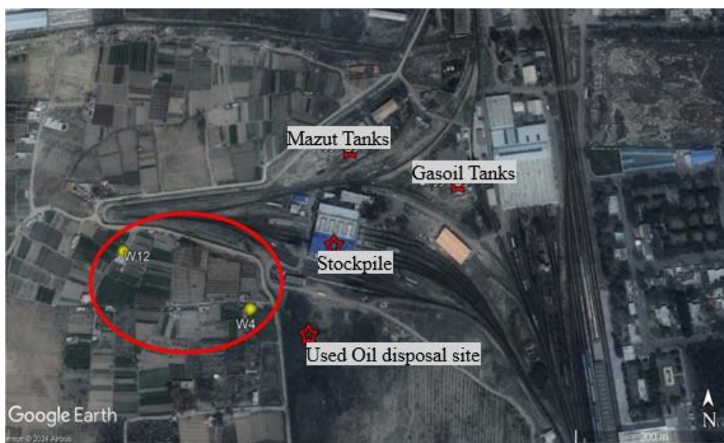
شکل ۱۳- چاه‌های هم منشأ W4 و W12 و منشأ آلودگی آن‌ها. Fig 13. Wells W4 and W12 with same origin, and their pollution sources.
