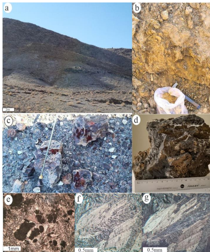
شکل ۲- (a) تصویر صحرایی سنگهای کربناته و عدسی‌های چرتی در مجاورت نهشته، (b) محصولات هوازده حاوی لیمونیت در سنگ دربرگیرنده، (c) نهشته منگنز برشی شده، (d) نمونه دستی پیرولوژیت بصورت پر کننده فضای خالی با بلورهای شعاعی و رگه‌های کلسیت، (e) تصویر مقطع صیقلی از پیرولوژیت با بافت پرکننده فضای خالی، PPL، (f) تصویر مقطع صیقلی پیرولوژیت با رخ مشخص، PPL و (g) تصویر مقطع صیقلی پیرولوژیت با رخ مشخص و انیزوتروپی، XPL.
