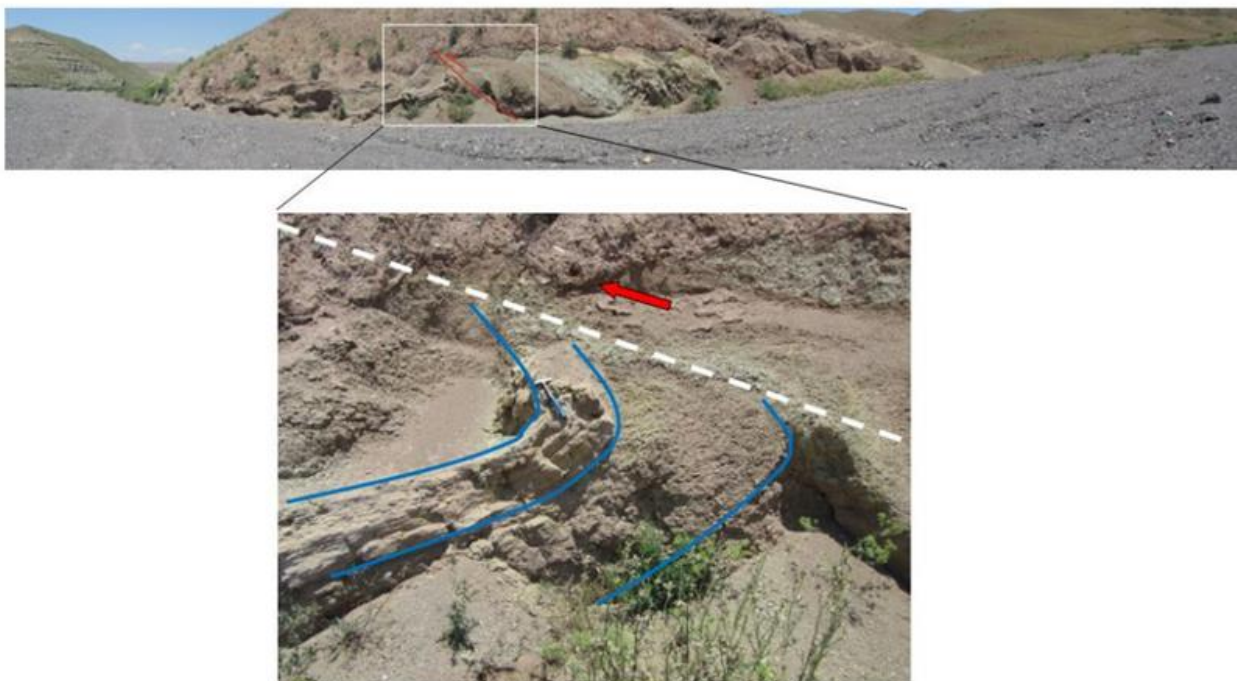
شکل ۳- راندگی واحدهای سنگی میوسن بر روی لایه‌های مارنی پلیوسن در جنوب رشته کوه چهل‌نور بر اثر عملکرد گسل گرمه‌چای (نگاه به شمال).
