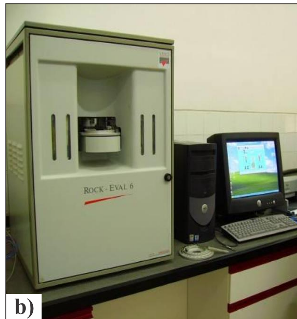
شکل ۳- شکل شماتیک آنالیز راک - ایول، IR آشکارگر فروسرخ و FID آشکارگر یونی شعله‌ای هستند (اقتباس از (Johannes et al., 2007)) (a)، و دستگاه راک - ایول ۶ مرکز تحقیقات زمین‌شناسی و زمین‌شیمی نفت دانشگاه شهید چمران اهواز (b).
