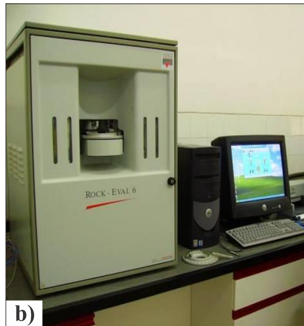
شکل ۳- شکل شماتیک آنالیز راک - ایول، IR آشکارگر فروسرخ و FID آشکارگر یونی شعله‌ای هستند (اقتباس از (Johannes et al., 2007)) (a)، و دستگاه راک - ایول ۶ مرکز تحقیقات زمین‌شناسی و زمین‌شیمی نفت دانشگاه شهید چمران اهواز (b). Fig. 3. Schematic illustration of the analytical set-up of the Rock-Eval pyrolysis instrument (Johannes et al., 2007) (a), and the Rock-Eval 6 instrument in the Petroleum Geology, and Geochemistry Research Centre (PGGRC) of Shahid Chamran University of Ahvaz-Iran (b).
