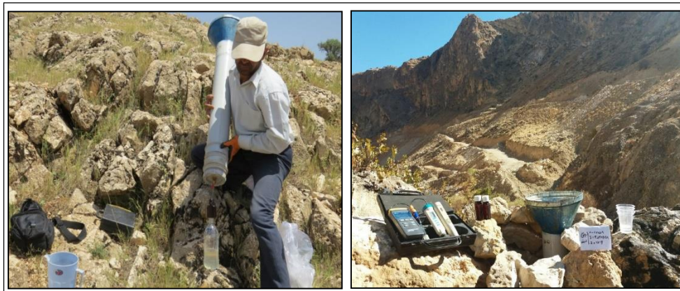
شکل ۲- نحوه نمونه برداری ایزوتوپی از بارش Fig. 2. The method of isotope sampling of precipitation
