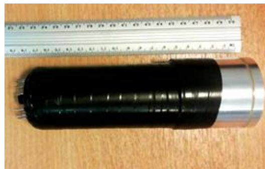
شکل ۲- نمایی واقعی از مجموعه آشکارساز (سوسوزن و لامپ تکثیرکننده نوری)
