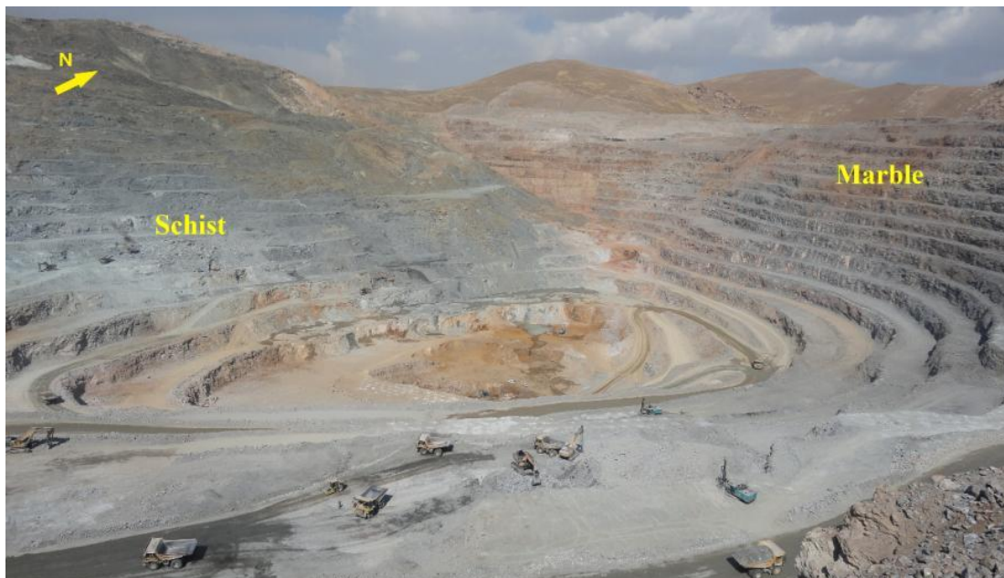
شکل ۲- فرادیواره مرمر و فرودیواره شیست در معدن انگوران.
