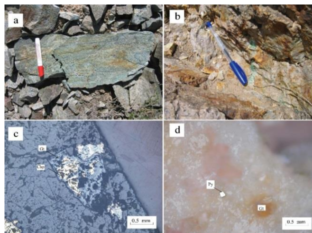
شکل ۴- (a) کانی‌سازی به صورت کربنات (مالاکیت) و نفوتوسیت، (b) کانی‌سازی کربنات (مالاکیت) دگرسانی سیلیسی، (c) تصویر میکروسکوپی از کانی کالکوپیریت که به گوتیت تبدیل شده و (d) پیریت ریزدانه که به گوتیت تبدیل شده است.
