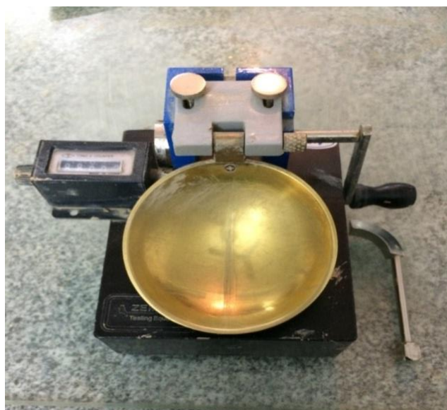
شکل ۳- دستگاه کاساگرانده برای تعیین حد روانی خاک مورد مطالعه.
