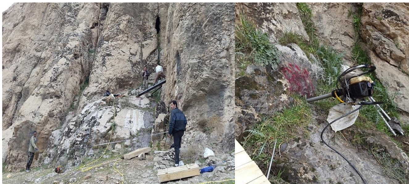
شکل ۱- تصویری از مغزه‌گیری سنگ در ایستگاه آبشار مصنوعی.
