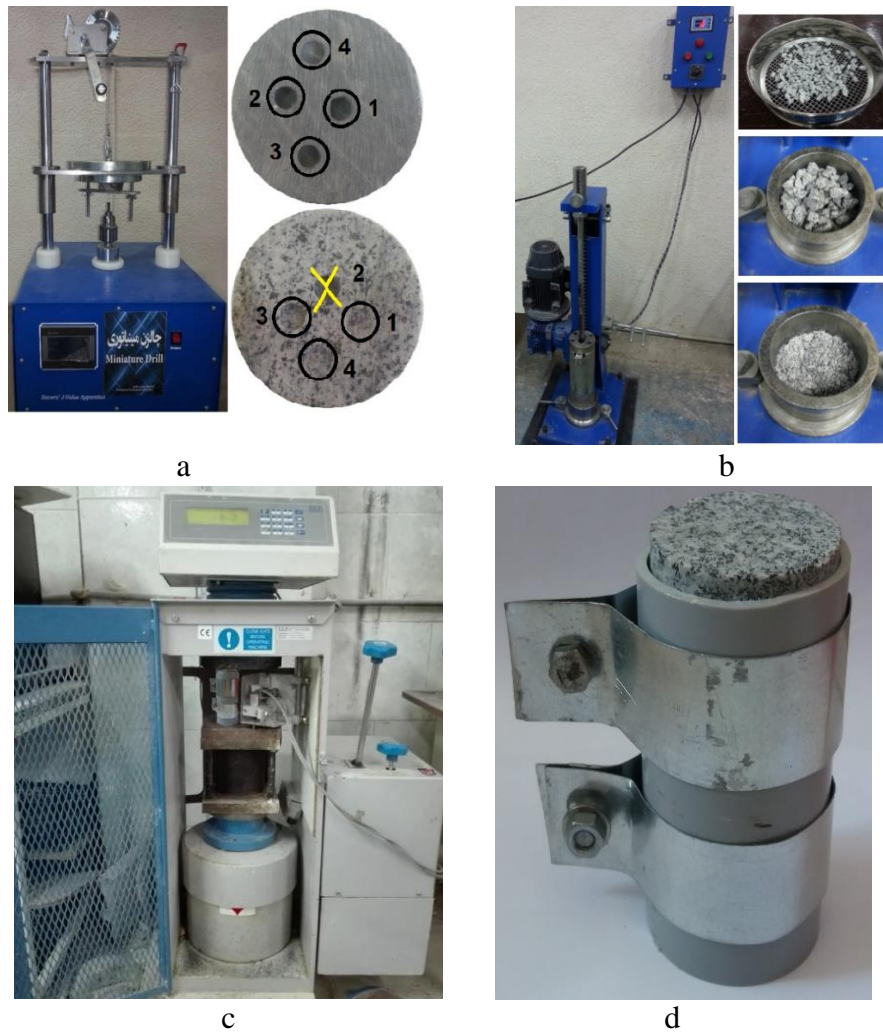
شکل ۴- تصاویری از (a) دستگاه آزمایش سیورزجی، (b) دستگاه آزمایش شکنندگی، (c) دستگاه آزمایش مقاومت فشاری تک محوری و (d) نگهدارنده.
