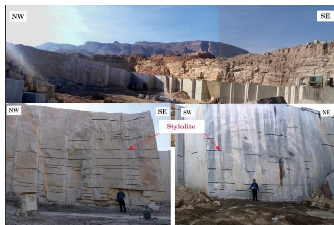
شکل ۱۰- نمای از جبهه کار ۱: ناپیوستگی‌های مؤثر با نظر گرفتن طول ناپیوستگی‌ها با تعداد فراوانی زیاد، استیلولیت‌ها می‌باشند که در این محدوده موازی با امتداد لایه‌بندی هستند.
