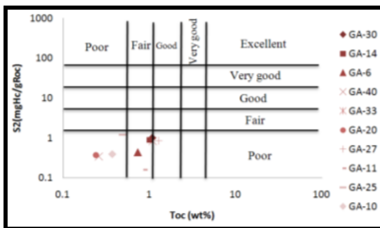
شکل ۸ - نمودار S 2 /TOC بیانگر پتانسیل هیدروکربن زایی می باشد (Peters, 1986).
