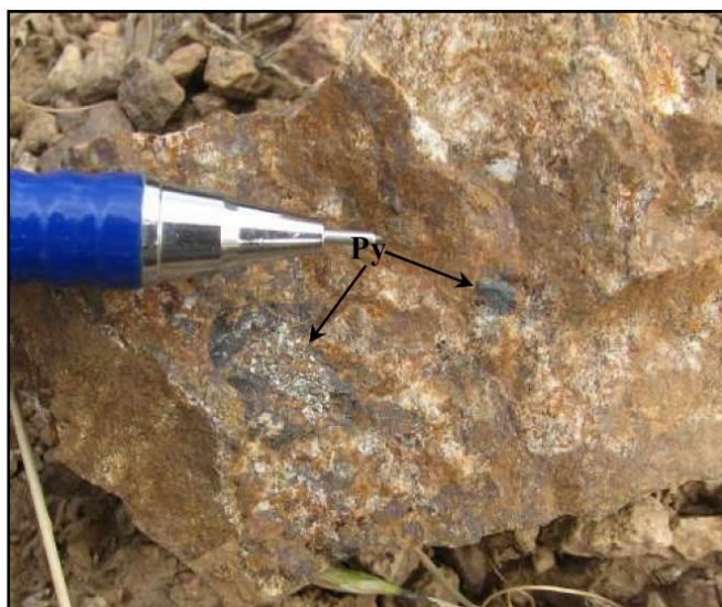
شکل ۴- نمونه‌ای از کانسنگ طلا، که با دگرسانی‌های سیلیسی- کربناتی- سریسیتی و تمرکز کانه‌های سولفیدی (عمدتاً پیریت Py) همراه است. Fig. 4. Landview of gold-bearing quartz-carbonate-sericite altered sample which associated with sulfide ores (mainly pyrite).
