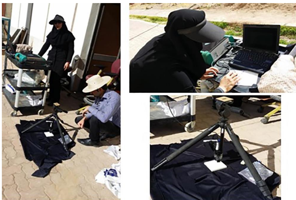
شکل ۳- دستگاه اسپکترورادایومتر فیلدسپیک ۳ و شرایط اندازه‌گیری نمونه در فضای باز.
