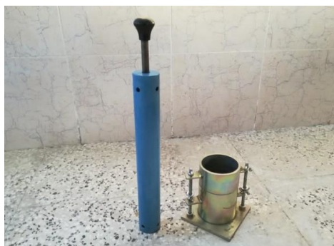
شکل ۵- چکش و قالب تراکم استاندارد استفاده شده در مطالعه حاضر. Fig. 5. Hammer and standard compression mold used in this study.
