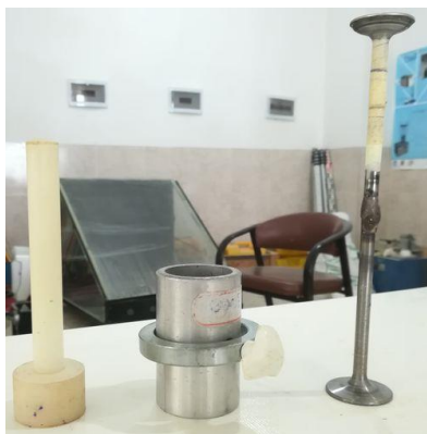
شکل ۶- قالب باز شو برای ساختن نمونه‌های مقاومت فشاری محصور نشده.
