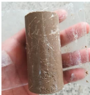
شکل ۷- یکی از نمونه‌های ساخته شده از خاک لس سیلتی برای آزمایش مقاومت فشاری محصور نشده.
