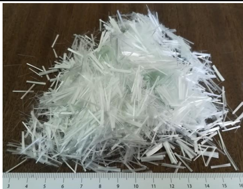
شکل ۴- الیاف شیشه نوع E استفاده شده در مطالعه حاضر. Fig. 4. Type E glass fibers used in this study.
