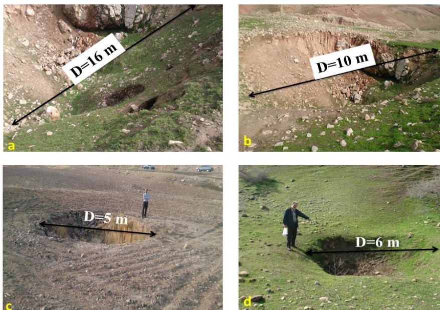
شکل ۱۰- انواع فرو چاله‌های تشکیل شده در غرب و مرکز منطقه پژوهش، (شکل های a و b) نوع ریزشی با قطر بیش از ۱۰ متر و (شکل های c و d) فروچاله‌ها فرونشستی با قطر کمتر از ۶ متر هستند.
