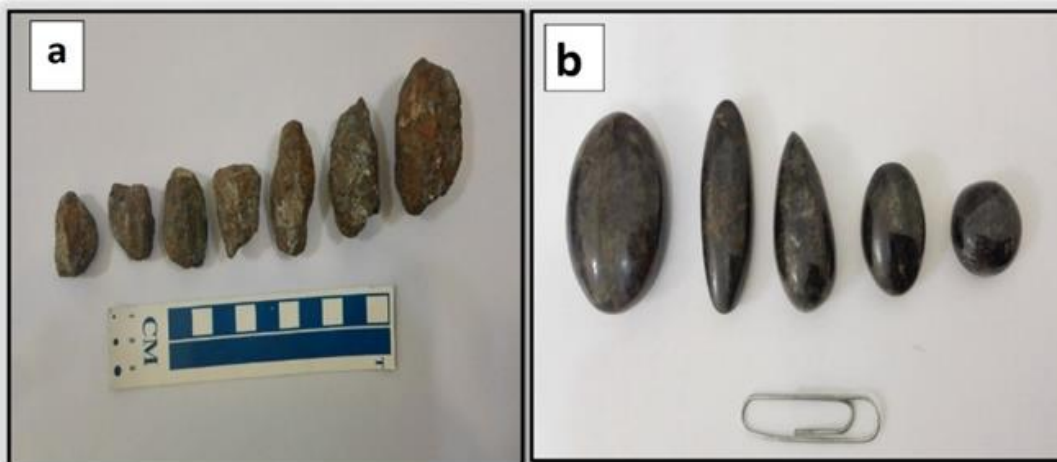
شکل ۴- (a) نمونه‌های کردپریت گوهری قبل از تراش و صیقل که به رنگ خاکستری می‌باشند و (b) نمونه‌های گوهری کردپریت که بعد از تراش و صیقل به رنگ قهوه‌ای تیره تا سبز. Fig.4. (a) Grey colour Ctd gem sample before cabochon and fantasy cut, and (b) Ctd gem sample after cabochon and fantasy cut with brown to green colour.
