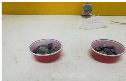
شکل ۹- اندازه‌گیری چگالی نمونه‌های غیر منظم. Fig. 9. Measuring the density of irregular samples.
