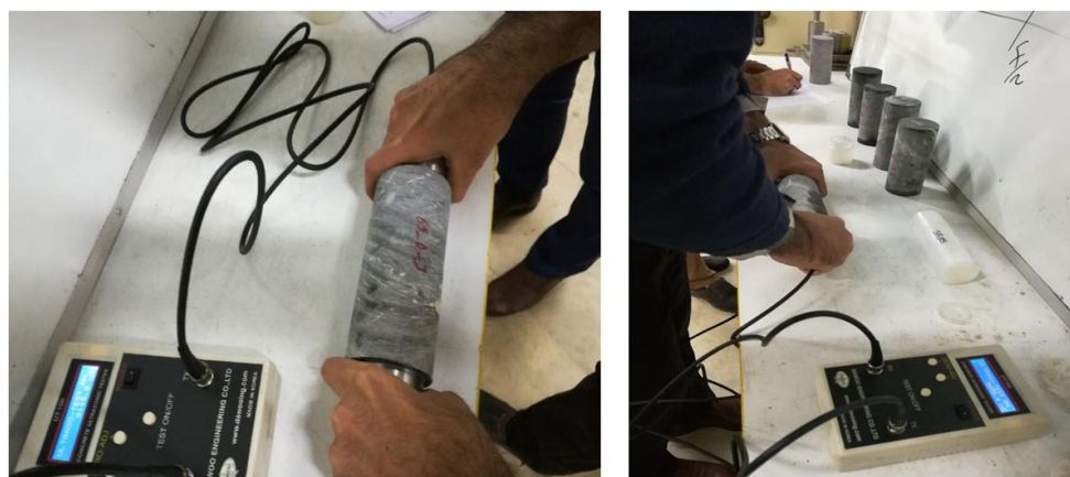
شکل ۷- اندازه‌گیری سرعت موج فشاری نمونه‌های سنگ شیست.
