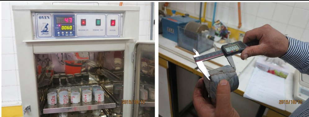
شکل ۸- اندازه‌گیری چگالی نمونه‌های منظم. Fig. 8. Measuring the density of regular samples.
