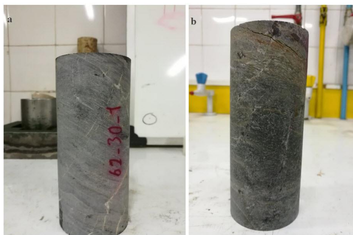
شکل ۱۲- (a) تصویر نمونه بکر و (b) نمونه هوازده (بعد از ۷۵ چرخه انجماد-ذوب).
