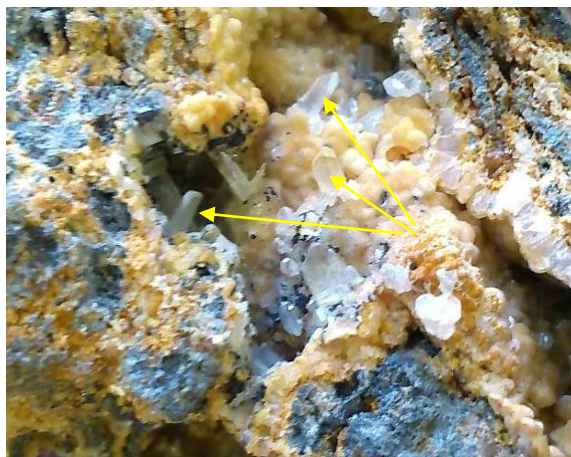
شکل ۱۲. تشکیل بلورهای تیغه‌ای سروزیت (Ce) در فضاهای خالی
