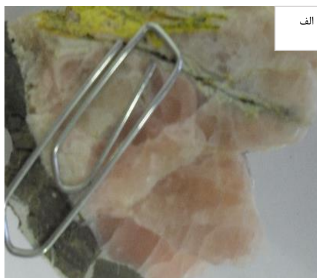
شکل ۸. الف) پیریت به صورت هم‌رشدی با اسفالریت تشکیل شده است، ب) بلورهای خوش‌شکل پیریت در رگچه‌ی کربناتی - سیلیسی (اسمیت‌زونیت (Sm) - کوارتز (Qz)) درون اسفالریت Sph.
