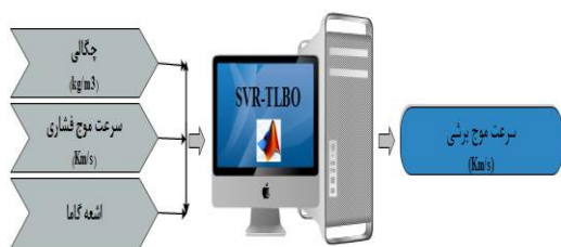
شکل ۴. ساختار روش هوشمند ترکیبی استفاده شده در این پژوهش
