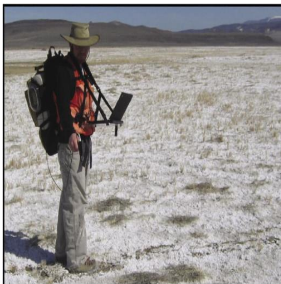
شکل ۲. طیف سنج ASD به کار برده شده در چاه‌های نمک. هم تینکالکونیت و هم هالیت در عکس به عنوان پوسته‌های تبخیری شورهای دیده می‌شوند (Krattl et al. 2006)
