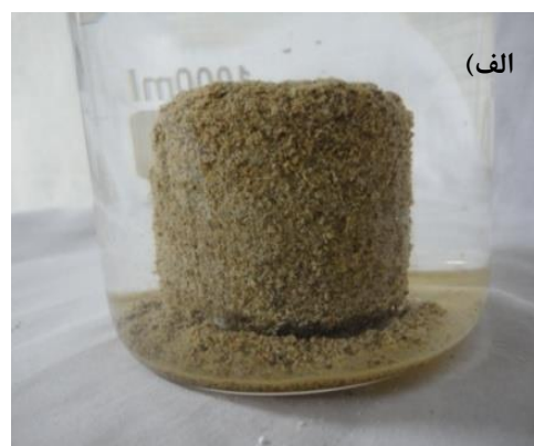
شکل ۹. نمایش تخریب‌های ایجاد شده در ماسه سنگ‌های مورد مطالعه در طی آزمایش دوام استاتیکی در محلول سولفات سدیم. الف) تخریب به صورت دانه‌های ماسه در نمونه تک تکاب، ب) تخریب به صورت دانه‌های ماسه و پوسته پوسته شدن در نمونه سه راه تپه اهواز.
