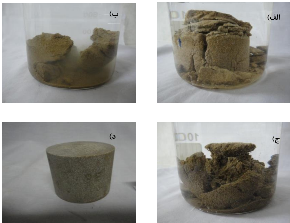
شکل ۸. نمونه‌هایی از تغییرات ظاهری ماسه سنگ‌های آغاچاری در طی آزمایش دوام استاتیکی در محلول سولفات سدیم. (الف) نمونه رگ سفید پس از ۲۸ روز، (ب) نمونه سوسنگرد بعد از ۱۴ روز، (ج) نمونه ام‌الدیس پس از ۷ روز، (د) نمونه لالی پس از ۴۲ روز.
