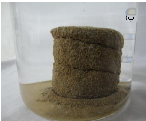
شکل ۹. نمایش تخریب‌های ایجاد شده در ماسه سنگ‌های مورد مطالعه در طی آزمایش دوام استاتیکی در محلول سولفات سدیم. الف) تخریب به صورت دانه‌های ماسه در نمونه تک تکاب، ب) تخریب به صورت دانه‌های ماسه و پوسته پوسته شدن در نمونه سه راه تپه اهواز.
