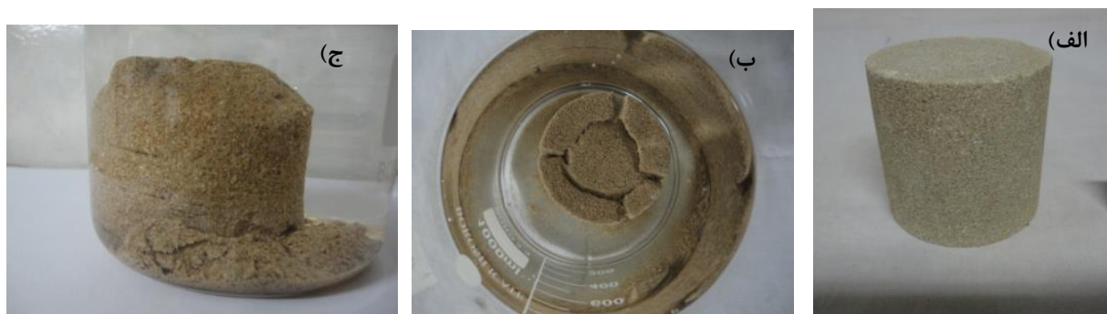
شکل ۷. تغییرات ظاهری ماسه سنگ رگ سفید در طی آزمایش دوام استاتیکی در آب مقطر. (الف) قبل از آزمایش، (ب) در انتهای روز ۲۸، (ج) انتهای روز ۴۲.
