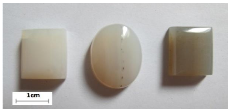
شکل ۱۰. افزایش کیفیت صیقل خوری از آگات‌های دارای بافت اسفرولیتی تا واربولیتی (آگات‌های سفید) به سمت آگات‌های دارای بافت واربولیتی (آگات‌های خاکستری کم رنگ) و آگات‌های دارای بافت میکروگرانولار تا کریپتوگریستالین (آگات‌های خاکستری).
