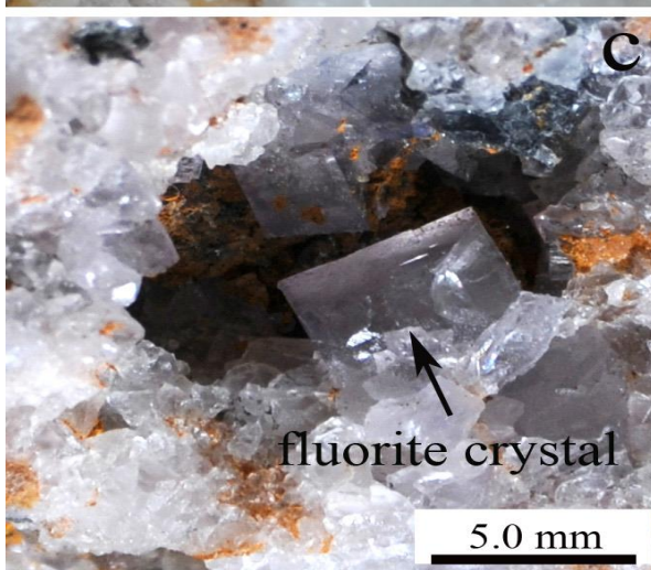
شکل ۳. (a) رگه فلوریت تقریباً قائم که شیستوزیته سنگ های میزبان (اسلیت و فیلیت) را قطع می نماید؛ (b) هم رشدی فلوریت با کوارتز و کلسیت، اکسیدهای آهن ثانویه نیز دیده می شود؛ (c) بلور مکعبی بی رنگ از فلوریت تأخیری که در فضای خالی رشد کرده است.
