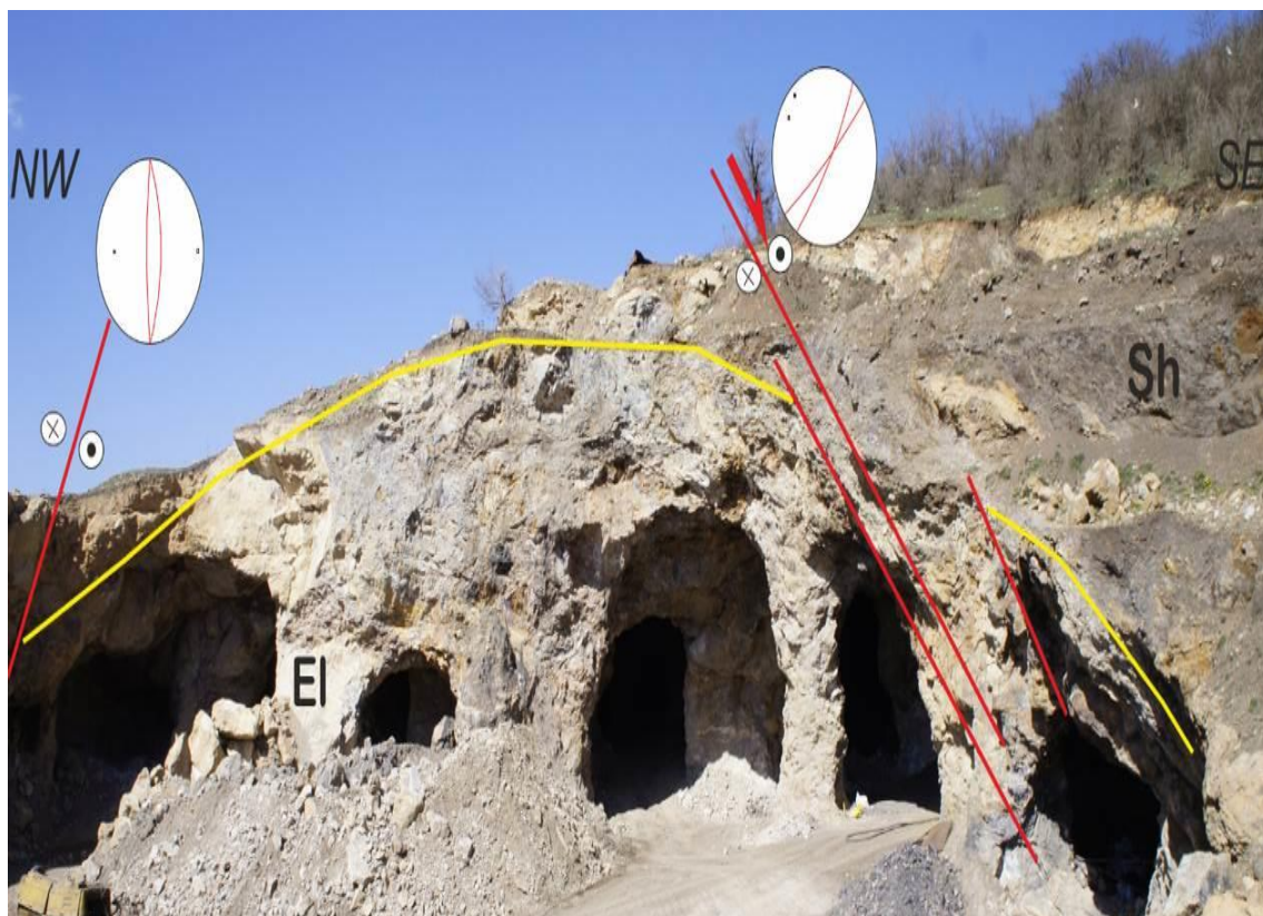
شکل ۴. نمایی از بخش مرکزی و تونل‌های حفاری معدن کمرپشت-۱، تونل‌ها به موازات محور طاقدیس حفاری شده است.
