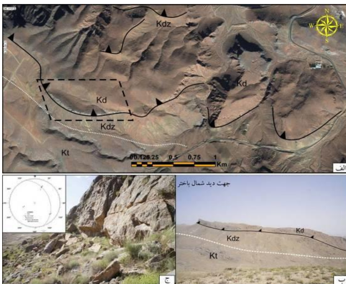
شکل ۵. الف- تصویر ماهواره‌ای از منطقه بدخش و باختر آن. ب- نمایی از راندگی واحد دولومیتی سازند تفت (Kd) بر روی واحدهای شیلی دره زنجیر (Kdz). موقعیت عکس بر روی تصویر ماهواره‌ای به صورت کادر خط‌چین مشخص شده است. ج- تصویر سطح گسل به همراه استریوگرام آن در سمت باختر منطقه بدخش. جهت دید شمال باختر
